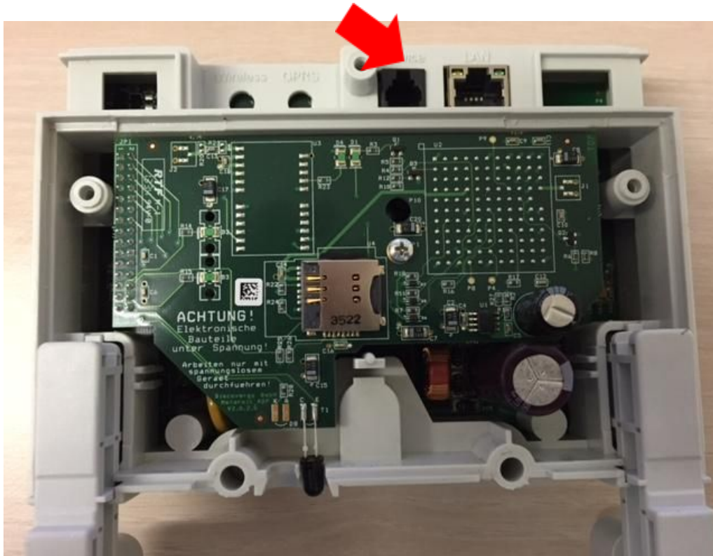
Bild 2: Service-Schnittstelle des Meteorit für das RS485-Kabel
